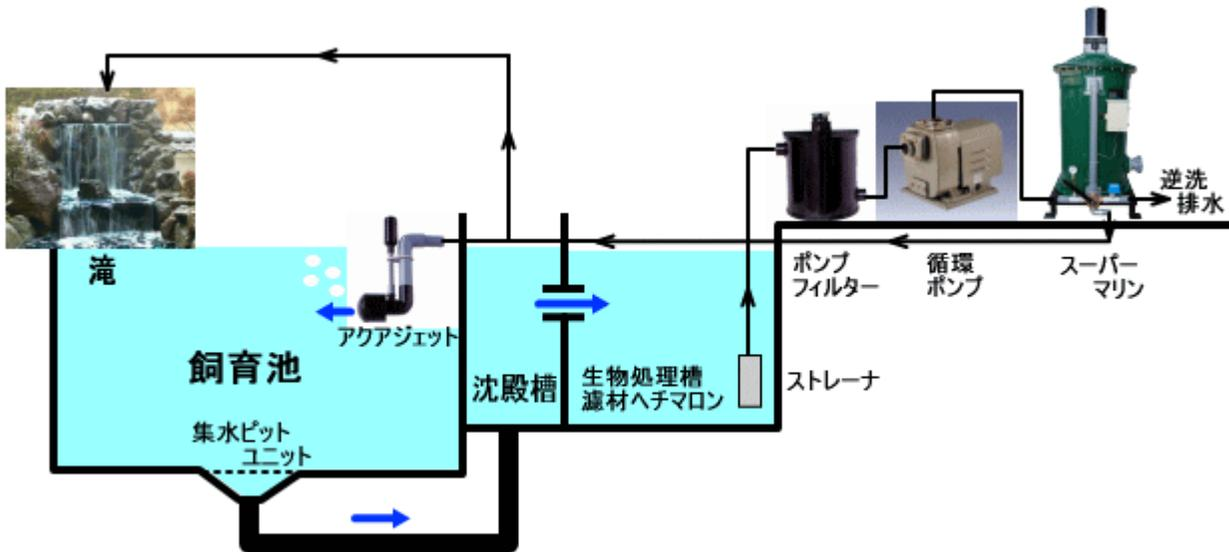
1. 濾過循環フローシートを参考に配管します。
