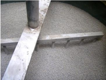
注意：攪拌器が埋まらないように注意し、濾過砂利1分で調整して下さい。
