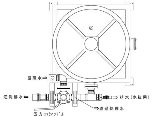
循環水(池水)：ポンプアップされた池水を濾過機に送り込みます。
